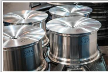
**Nachvollziehbar:** Jeder Rohling bekommt eine eigene Nummer, mit der jeder einzelne Prozessschritt zurückverfolgt werden kann.
