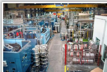
**Bewahrt:** Im alten Werk I stehen mehr als 19 Fräs- und Drehmaschinen, die das Rad als Rohling in die richtige Form bringen.
